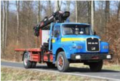
MAN 19.321 6-Zylinder-Turbohauber mit Doppel-H-Getriebe und Splitter sowie 110 km/h Spitzengeschwindigkeit
