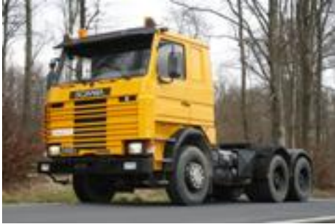
Scania 142 Schwerlast-Sattelzugmaschine mit AP-Achsen und der Radformel 6 x 4.
